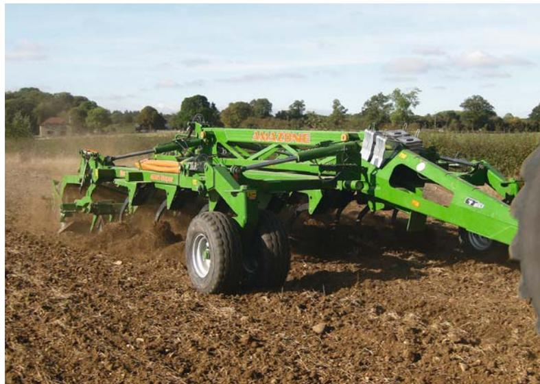
Выдержка глубины агрегатом Centaur производится в задней части при помощи колёс-катков диаметром 800 мм, а в передней части – посредством двойных копирующих колёс. Копирующие колёса агрегата Centaur служат для его стабилизации. Ведение самого агрегата на нужной глубине осуществляется через нижнюю тягу трактора.
