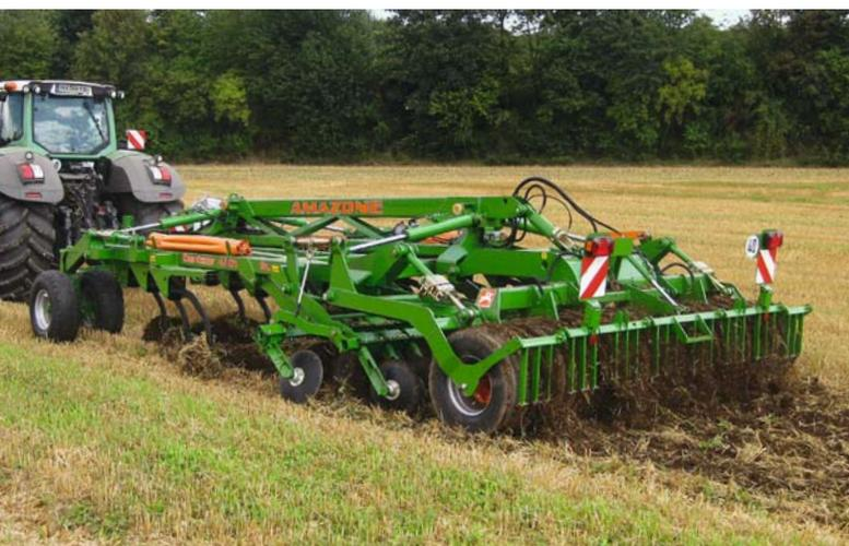
Для надёжного перемещения по дорогам общего пользования агрегаты Centaur шириной 4 и 5 м складываются при помощи гидравлической системы до транспортной ширины 3 м. Максимальная скорость движения по дорогам при наличии пневматической тормозной системы составляет 40 км/ч.
