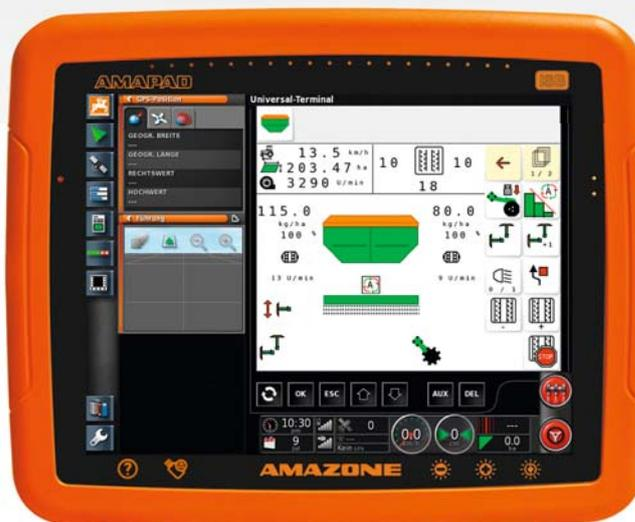
Наряду с переключением секций GPS-Switch pro установлена серийная, качественная, профессиональная система параллельного вождения GPS-Track pro. Ее можно дооснастить до автопилота.
