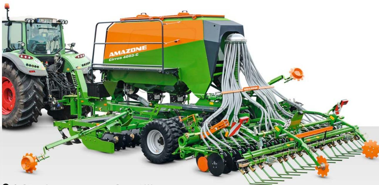
⊕ С объёмом 2-секционного напорного бункера 4.000 л – для посевного материала и удобрений
