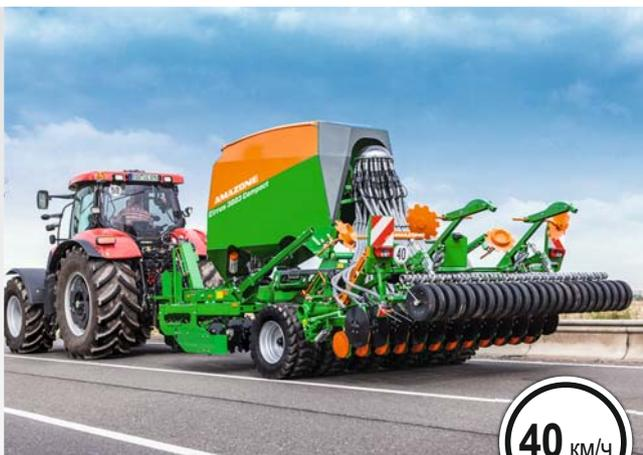
❗ «Серийно Cirrus оснащен замедленной пневматической тормозной системой – показательно! Еще лучше: машина может двигаться по общественным дорогам с полным бункером и со скоростью 40 км/ч».
