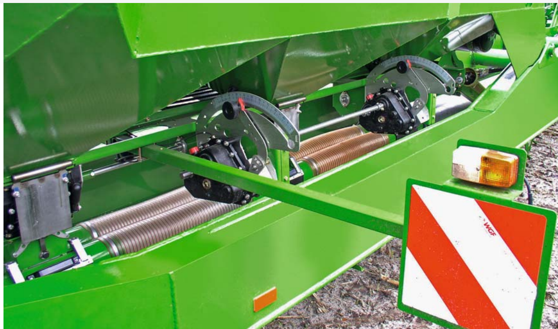
Редуктор Vario позволяет реализовать норму высева от 2 до 400 кг.
