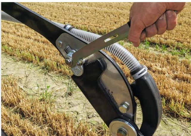
Настройка долотовидного сошника по глубине
