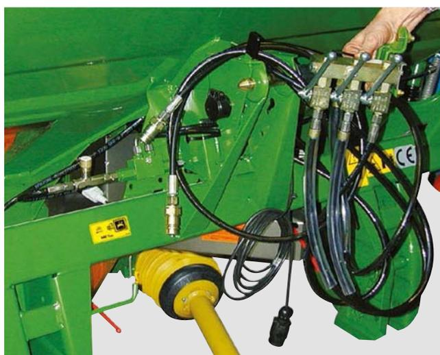
✔ На тракторах только с одним распределительным клапаном можно использовать электрический 3-линейный блок HyClick как удобный преселектор функций «Limiter» и «Двойные заслонки справа/слева».
