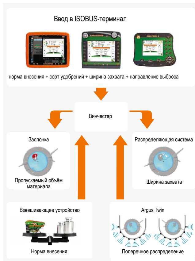
Концепция распределителей удобрений ZA-TS и ZG-TS с техникой Argus Twin и системой взвешивания
