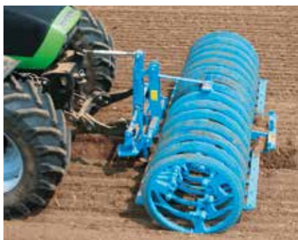
Устройство для фронтального навешивания
