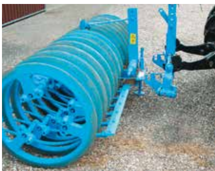
Универсальный фронтальный почвоуплотнитель WEP
