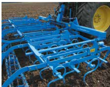
Прочная рама из пружинной стали
