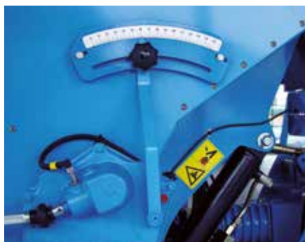
Бесступенчатый редуктор в масляной ванне
