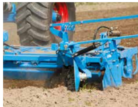
Направляющие диски для точного встречного движения
