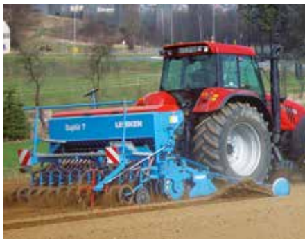
Точное движение благодаря маркеру
