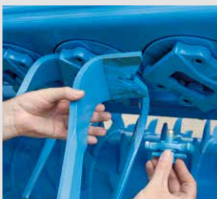
Быстрая замена ножей безболтового крепления
