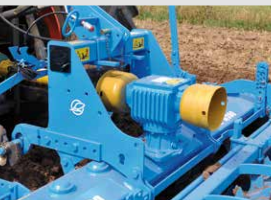
Простая силовая передача через редуктор со сменными шестернями
