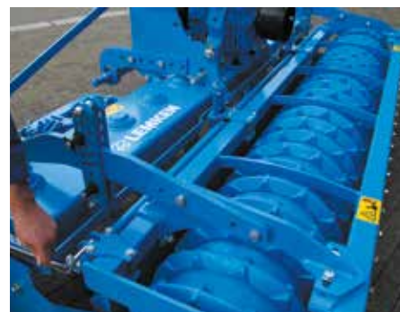
Выравнивающая планка для регулирования движения почвы
