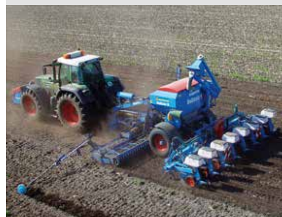
Равномерное распределение веса при помощи разгрузки шасси
