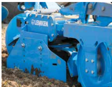
Боковые щитки для точного совмещения проходов по полю
