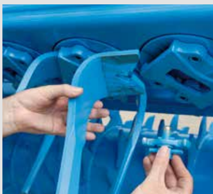
Быстрая замена ножей безболтового крепления
