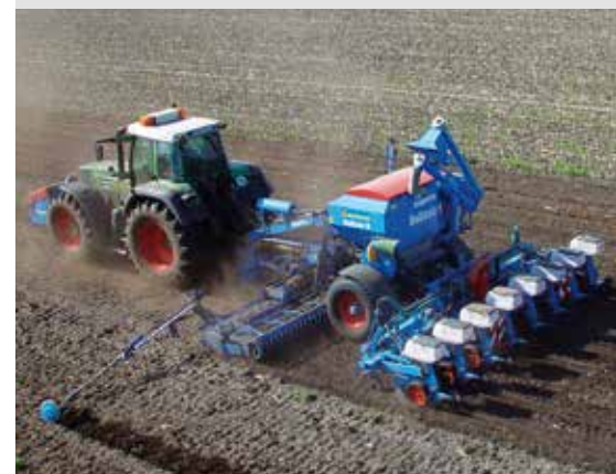
Равномерное распределение веса при помощи разгрузки шасси
