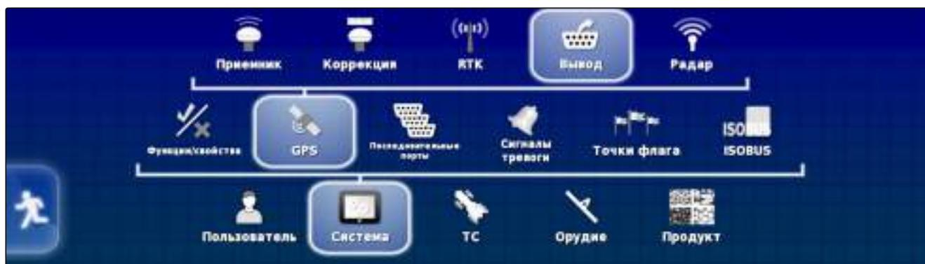
GPS-выход предназначен для передачи другим устройствам таких данных, как скорости, направления движения и положения.
