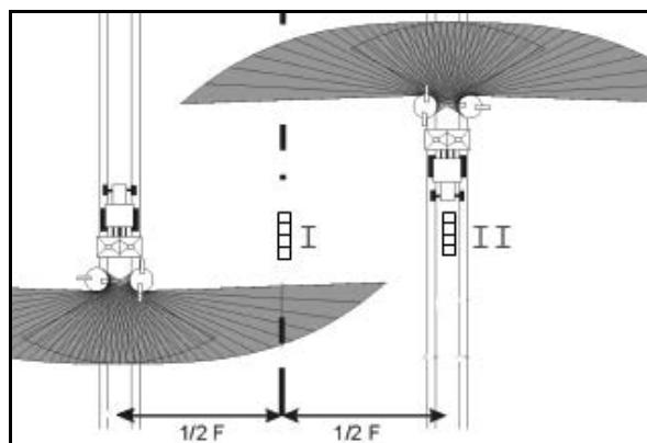
Расстояния для сборных емкостей отображаются в зависимости от ширины захвата.
