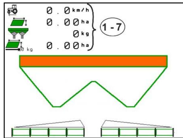
Счетчик расстояния обнуляется при закрывании заслонок на разворотной полосе и начинает измерять путь до момента открытия заслонок.
