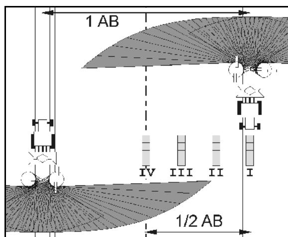
Расстояния для сборных емкостей отображаются в зависимости от ширины захвата.
