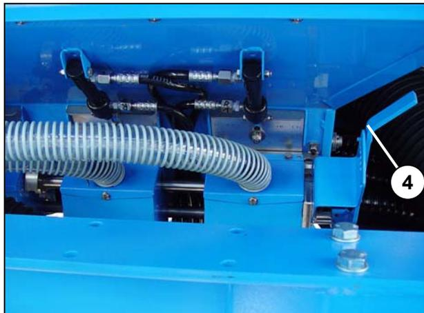
Донные заслонки дозирующего устройства для удобрений следует устанавливать при помощи рычага (4) в положение 1.
