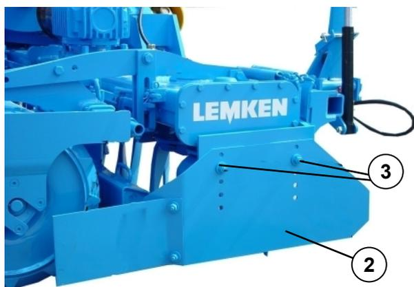
Подпружиненные боковые щитки (2) следует настроить на такую высоту, чтобы они полностью закрывали вращающиеся инструменты. При износе их следует соответственно опустить. После изменения высоты снова прочно затянуть винты (3).
