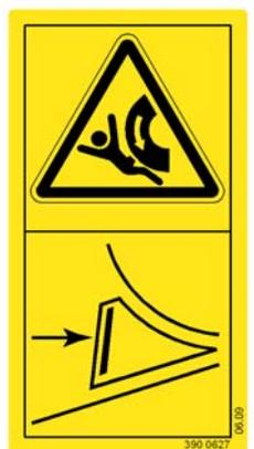
Перед отсоединением или отставкой заблокируйте агрегат с помощью противооткатных клиньев.
