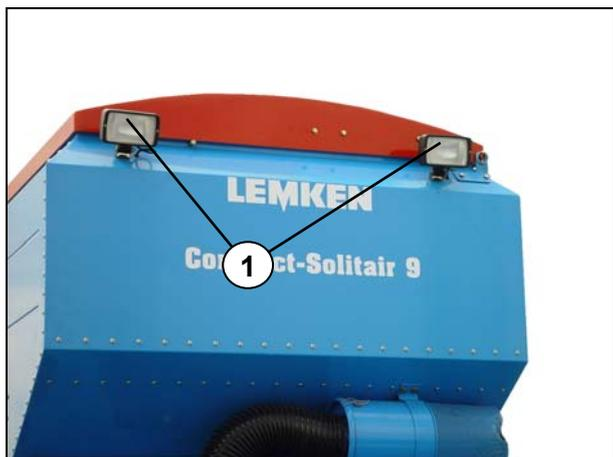
Фары рабочего освещения (1) включаются и выключаются с управляющего терминала в меню ввода. Осветительное оборудование трактора должно быть включено.
