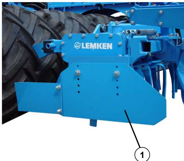
Вал отбора мощности трактора можно включать только в том случае, если ротационная борона опущена и находится на расстоянии всего нескольких сантиметров над почвой, а боковые щитки (1) не позволяют наступить на вращающиеся инструменты. Вал отбора мощности следует отключить, если расстояние между ротационной бороной и почвой превышает несколько сантиметров.
