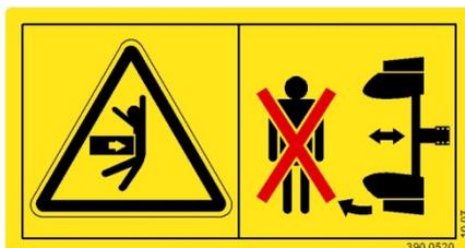
Не входите в рабочую зону и зону раскачивания агрегата.
