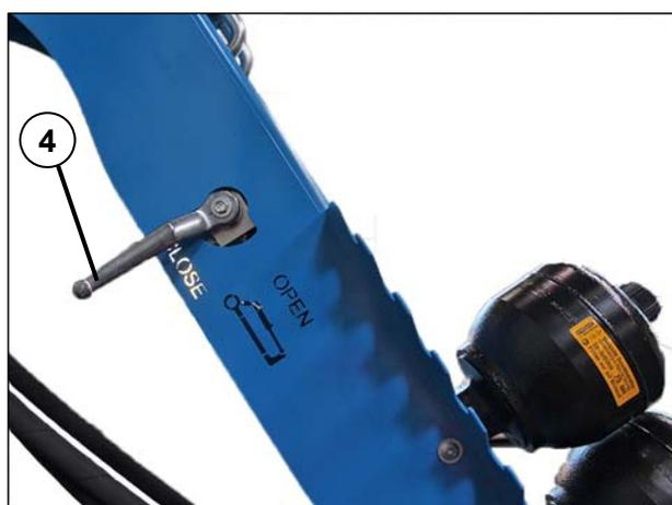
Для того чтобы можно было навесить плуг на трактор без риска, перекройте подачу давления в гидроцилиндр запорным клапаном (4).
