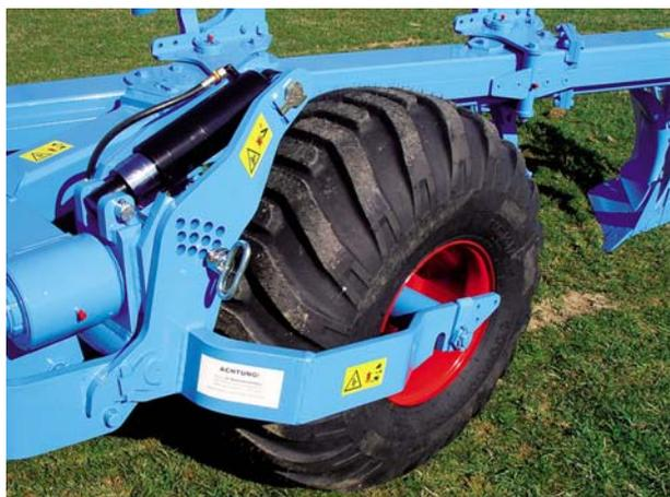
Небольшое давление на грунт при вспахивании благодаря большому опорному колесу повышенной проходимости.
