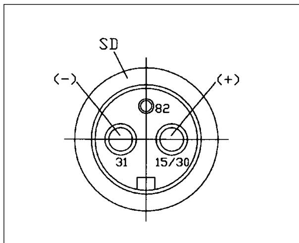
Для электропитания на тракторе должна иметься 3-полясная розетка, соответствующая стандарту DIN 9680.
