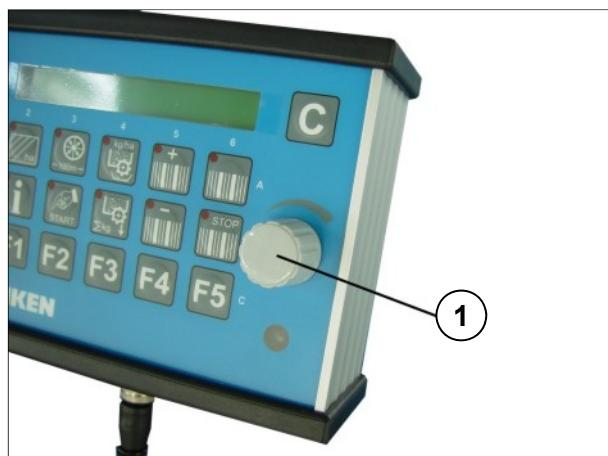
Значения и настройки выбираются с помощью поворотной ручки (1). В следующей части этого руководства встречаются указания "выбрать" или "ввести". При этом всякий раз имеется в виду пользование поворотной ручкой (1).
