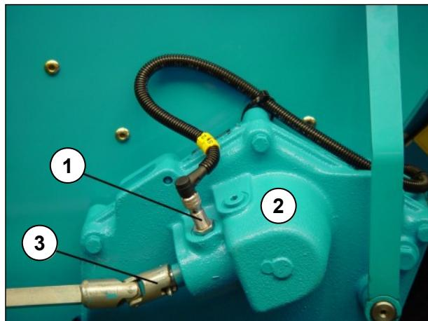
Для измерения пути с помощью датчика (1) вырабатываются импульсы, которые затем подсчитываются датчиком импульсов в редукторе (2).
