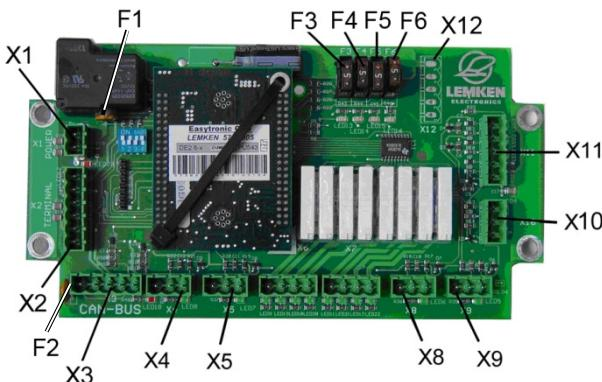
В общем блоке находится плата со штекерными гнездами, предохранителями и светодиодами.
