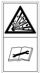
**ВНИМАНИЕ:** Гидроаккумулятор находится под давлением газа и масла. Его демонтаж и ремонт выполнять только в соответствии с техническим руководством!
