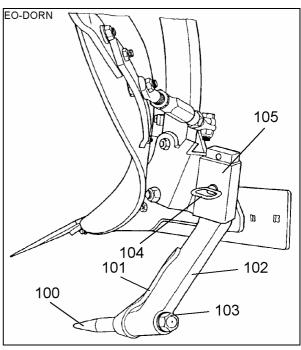
Стойка (102) защищена от износа при помощи защитного устройства стойки (101). Как защитное устройство стойки (101), так и глубинный рыхлитель (100) могут быть заменены после демонтажа гайки (103).
