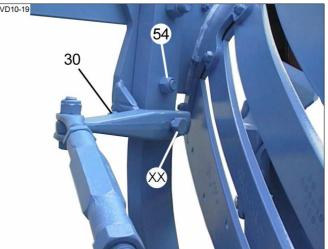
хорошее втягивание. После регулировки необходимо снова жестко затянуть регулировочные винты (30), корпусные винты (54) и зажимные винты (XX).
