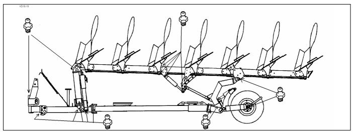
Подшипниковая труба пальца (LB) смазывается через смазочную трубку (SL) со смазочным ниппелем.
