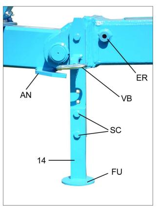
Теперь длина опорной стойки отрегулирована оптимально. В завершение жестко затянуть винты (SC).
