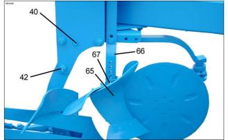
глубины Регулировка захвата производится у предплужников при плоской стойки помощи (66)посредством забивного штифта (67). В предплужниками сочетании С круглыми стойками (68) при помощи зажимных винтов (69) производится установка по глубине. После каждой следует произвести перестановки фиксацию как забивного штифта, так и зажимных винтов!
