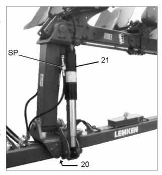
**ВНИМАНИЕ**: После проведения навешивания необходимо проверить, достаточен ли зазор между нижними тягами навесного устройства и башней плуга при полностью выглубленном подъёмном гидравлическом устройстве и опущенной задней частью плуга.
