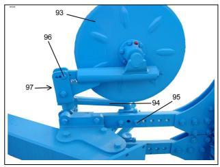
**ВАЖНО:** На плуге ЕвроДиамант зажимные винты (95) держат пару дисков без разделения на правый и левый диск, как на ВариДиамант. Здесь после регулирования глубины, прежде чем затягивать зажимные винты, необходимо убедиться в том, что противолежащие дисковые ножи находятся в требуемом положении и что они не сместились.
