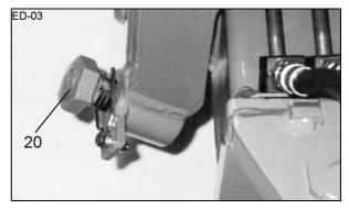
гидравлики, а затем снова полностью опустить = в результате винт регулировки наклона (20) разгружается. Отрегулировать наклон, как это необходимо (используя гаечный ключ на 46 мм) и привести подъемную гидравлику в первоначально настроенное положение.
