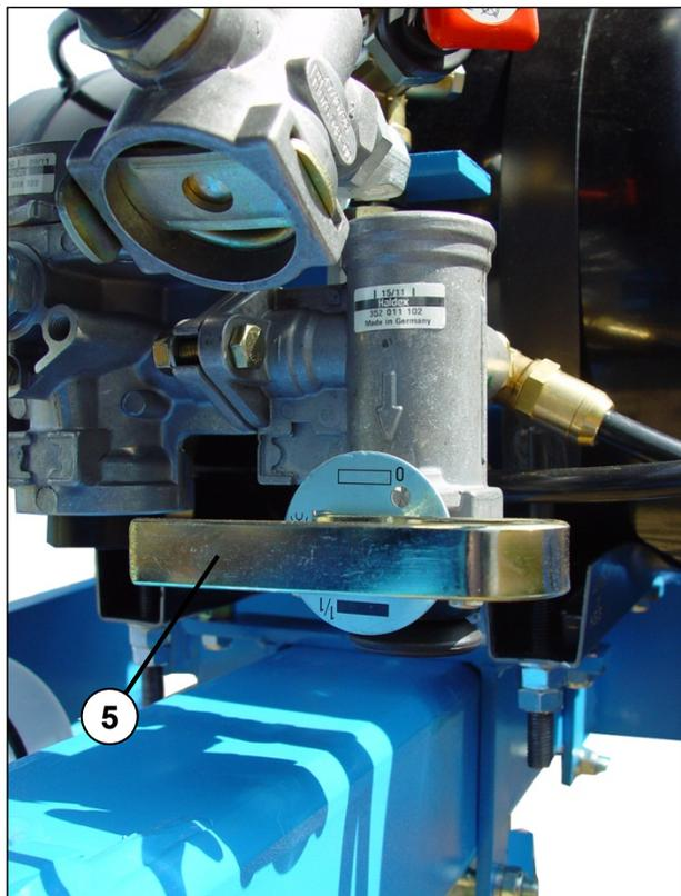
При помощи регулятора тормозных сил (5) можно соответствующим образом настроить тормозное действие тормозной системы в зависимости от осевой нагрузки.
