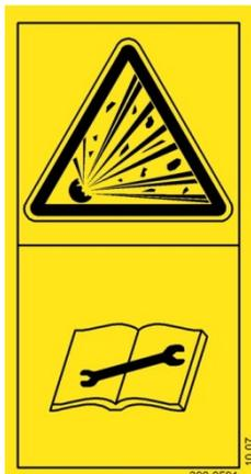
Гидроаккумулятор находится под давлением газа и масла. Его демонтаж и ремонт выполнять только в соответствии с техническим руководством.
