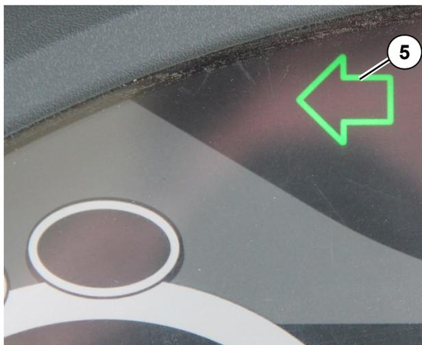
• Если мигает только контрольная лампа указателя направления движения трактора (5), осветительное оборудование агрегата подключено неправильно или не работает.
