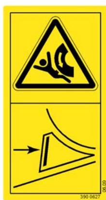
Перед отсоединением или отставкой заблокируйте агрегат с помощью противооткатных клиньев.
