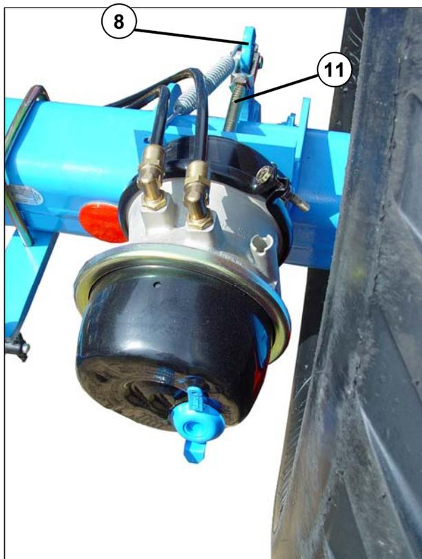
Если рабочее давление пневматической тормозной системы опускается ниже 3,0 бар, тормоз затягивается с помощью пружины тормозного цилиндра. При этом тормозная тяга (11) слегка выдвигается и затягивает тормоз посредством тормозного рычага (8).
