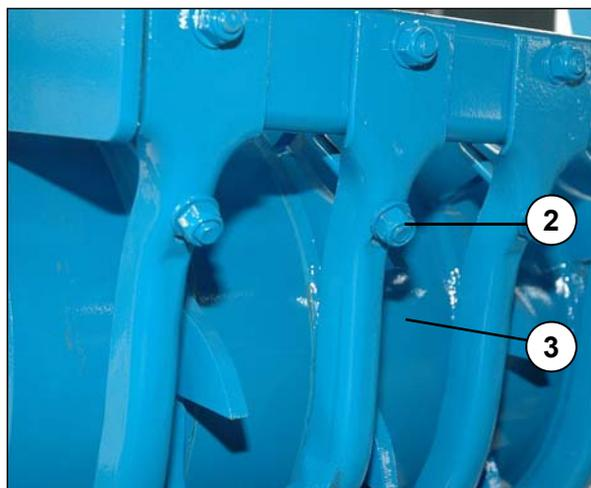
Скребки (1) регулируются установочными гайками (2).
