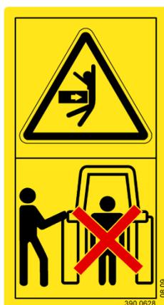
При пуске трехточечного силового подъемника находиться вне зоны хода трехточечного механизма навески.
