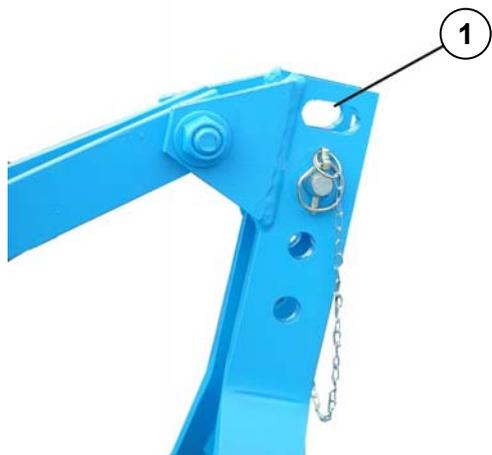
Если во время работы агрегат раскачивается либо возникают неконтролируемые самопроизвольные качения, необходимо либо выбрать более глубокую рабочую глубину, либо работать на более высокой скорости. Если данные действия не имеют результата, необходимо соединить верхнюю тягу с продольным отверстием (1).
