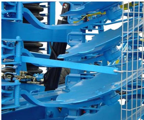
Защитные приспособления полусферических дисков
