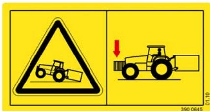
**ВНИМАНИЕ!** Передняя ось трактора должна быть постоянно нагружена как минимум 20% веса трактора в порожнем состоянии!
