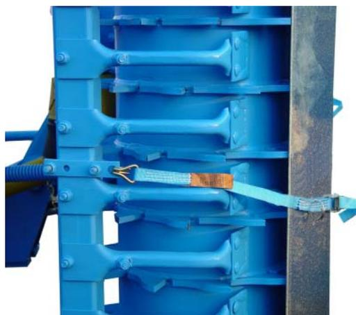
Защитное приспособление зубчатого катка
