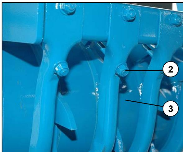
Скребки (1) регулируются установочными гайками (2).
