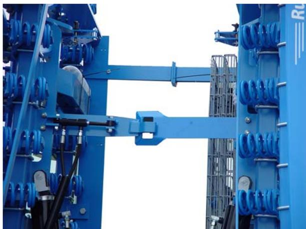
Гидравлическое устройство раскладывания
