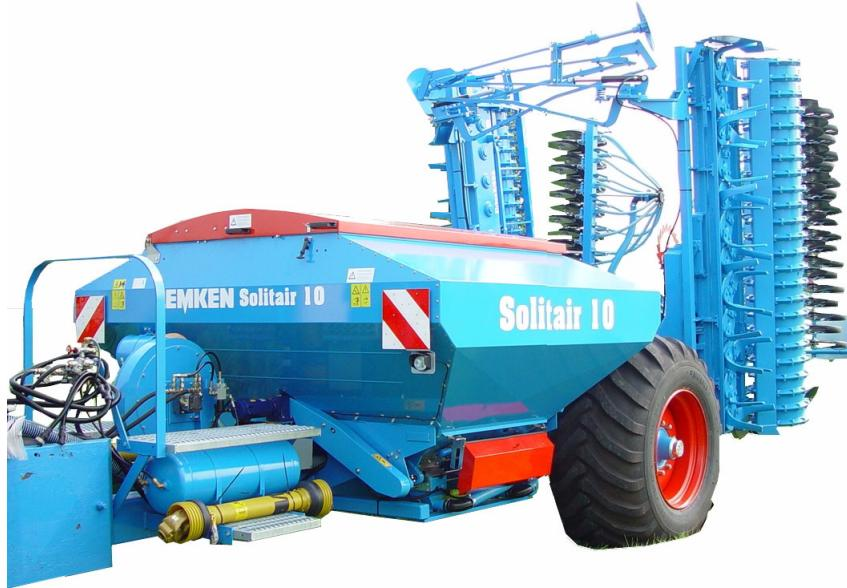
**ВНИМАНИЕ!** При не опущенном почвообрабатывающем агрегате и смонтированном Цирконе 9/600 К или Цирконе 10/600 К дышло или передняя часть рядовой сеялки могут ударить вверх. Опасность несчастного случая!
