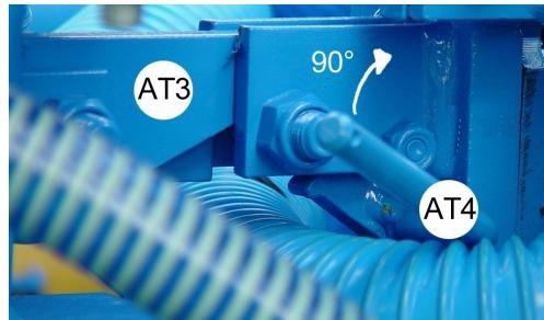
Повернуть отпирающий рычаг (AT4) приблизительно на 90°, чтобы отцепить фиксирующий крюк (AT3).
