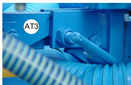
Высевная поперечина заблокирована, фиксирующий крюк (AT3) зацеплен.
