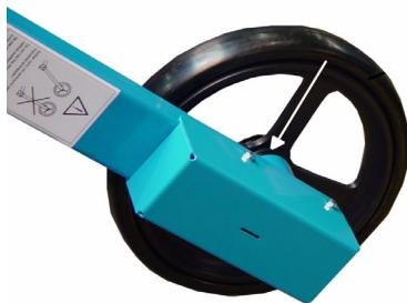
Датчики должны быть отрегулированы на расстояние 2 мм от импульсного колеса или датчика импульсов с допуском +/- 1 мм.
