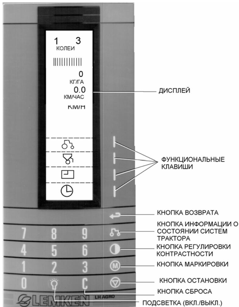
**Внимание!** При постановке трактора с рядовой сеялкой «СОЛИТЭР» на хранение бортовой компьютер должен быть отключен, чтобы предотвратить разряд аккумуляторной батареи.
