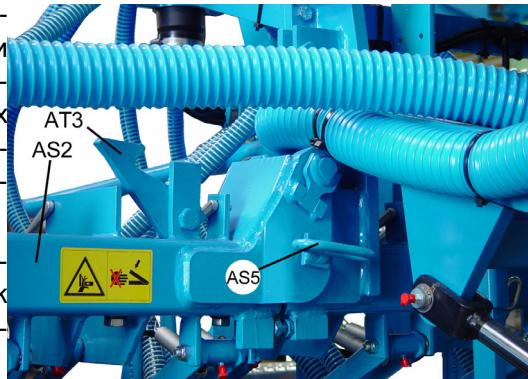
Если сеялка Solitair 9 навешена на почвообрабатывающее орудие ЛЕМКЕН, гидрошланги привода поперечины можно подключить к разъемам с красными защитными колпачками.
