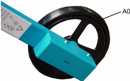
При поднятой высевной поперечине импульсное колесо должно быть расположено не более чем на 5 см ниже роликов ведения на глубине или уплотняющих катков (D5) сошников с двойными дисками (D4), однодисковых и анкерных сошников.
