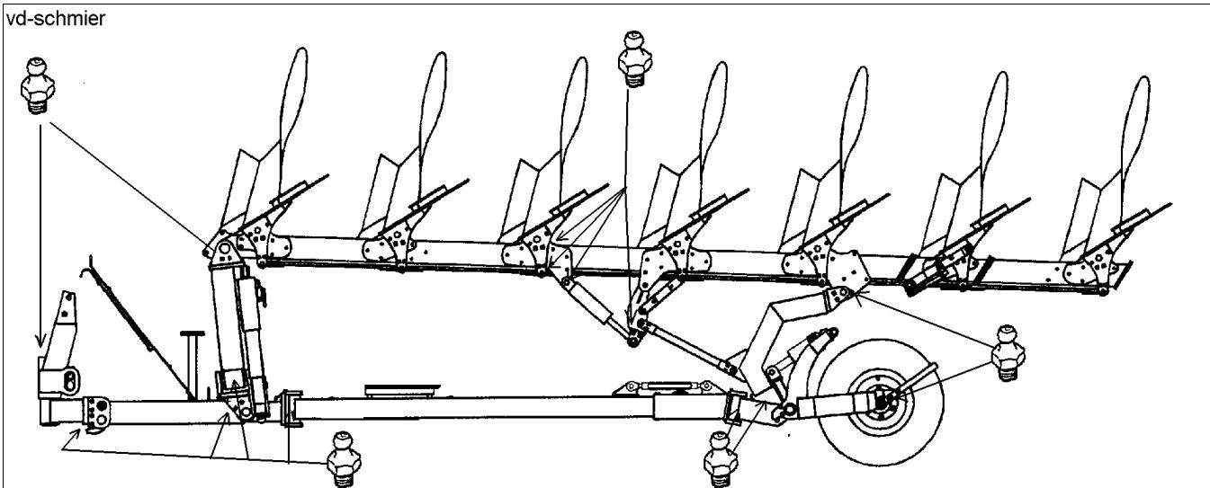
Все болты и гайки, в частности болты колёс, должны регулярно проверяться и при необходимости подтягиваться. Шланги высокого давления должны меняться через каждые 6 лет! Пористые или неисправные шланги высокого давления необходимо незамедлительно менять! Изношенные сошники, кромки отвалов, отвалы и т.д. следует своевременно менять, чтобы не повредились стойки корпусов или несущие части.
