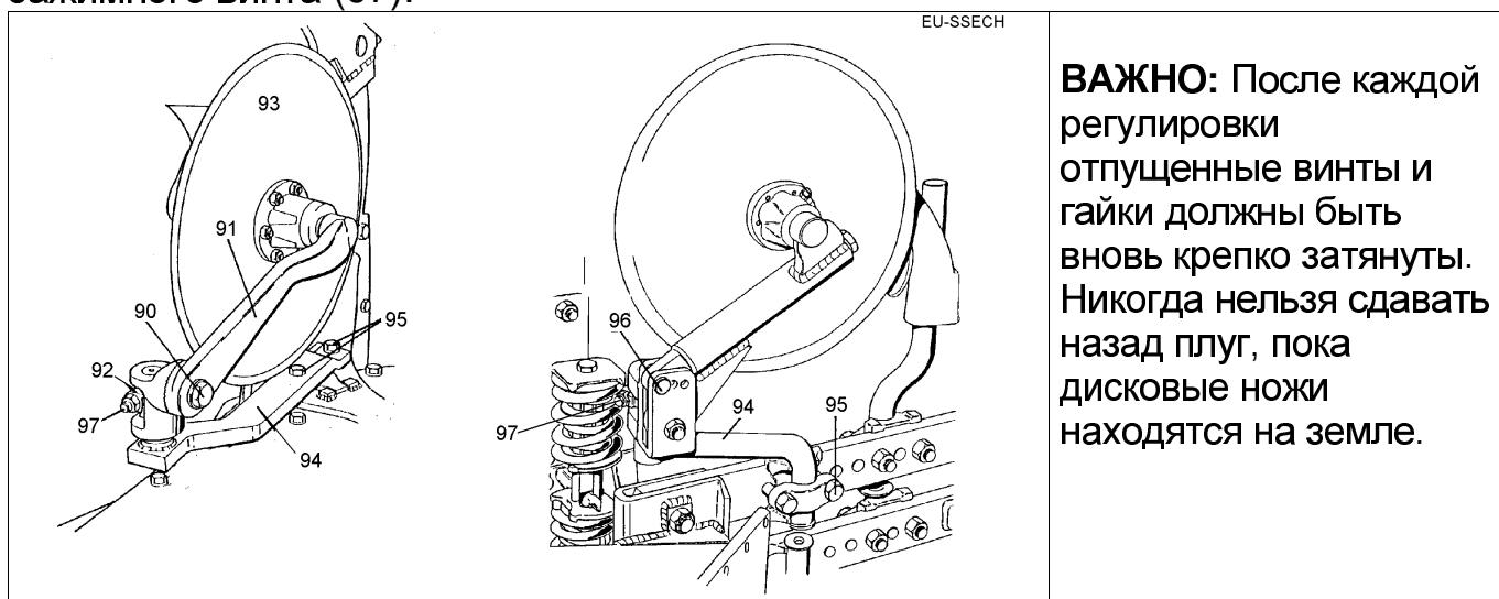
**ВАЖНО:** После каждой регулировки отпущеные винты и гайки должны быть вновь крепко затянуты. Никогда нельзя сдавать назад плуг, пока дисковые ножи находятся на земле.
