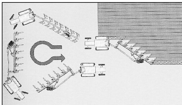
Одновременно трактор поворачивается к невспаханному участку и описывает при этом петлю. При вступлении в следующую борозду плуг должен быть повернут в направлении разворота.
