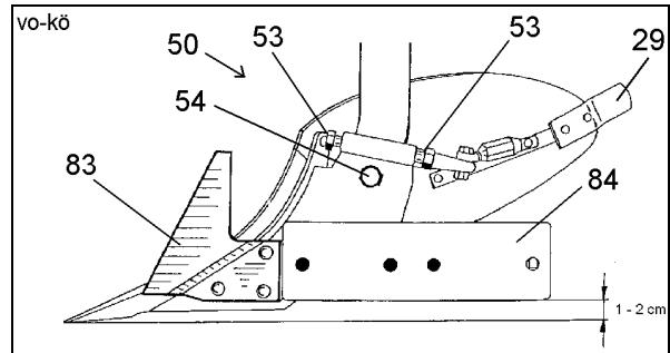
Необходимые регулировки осуществляются посредством установочных винтов (53) vorgenommen, после того как отпущены винты корпуса (54). Если проникновение плуга в почву является неудовлетворительным, то улучшения можно достичь посредством несколько большей постановки корпусов плуга «на носок» при помощи установочных винтов (53). Однако не следует злоупотреблять такой перестановкой; результатом подобных действий было бы возрастание тягового сопротивления и ухудшение заглубления.
