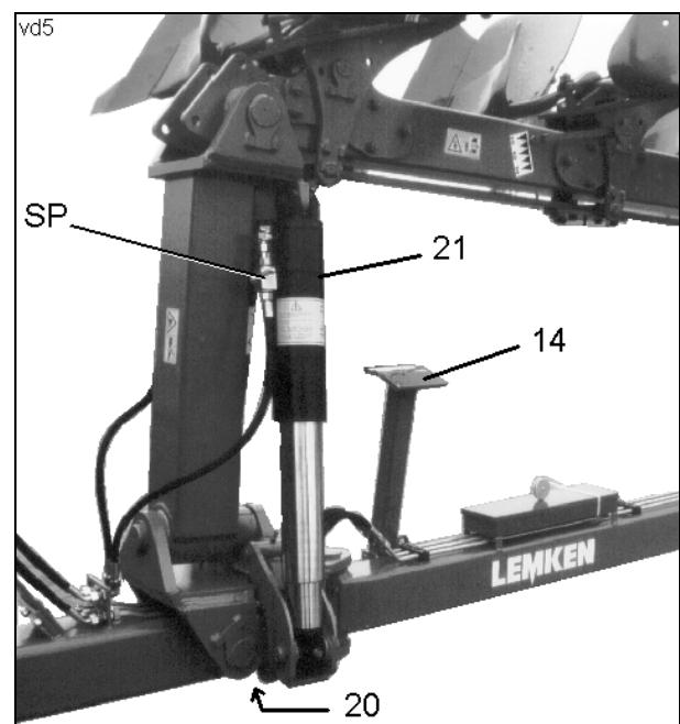
**ВНИМАНИЕ:** После проведения навешивания необходимо проверить, достаточен ли зазор между нижними тягами навесного устройства и башней плуга при полностью выглубленном подъёмном гидравлическом устройстве и опущенной задней частью плуга. Кроме того, необходимо проверить, может ли этот плуг быть повернут по отношению к трактору на 90°. Зона поворота ограничена, если трактор шире 250 см.
