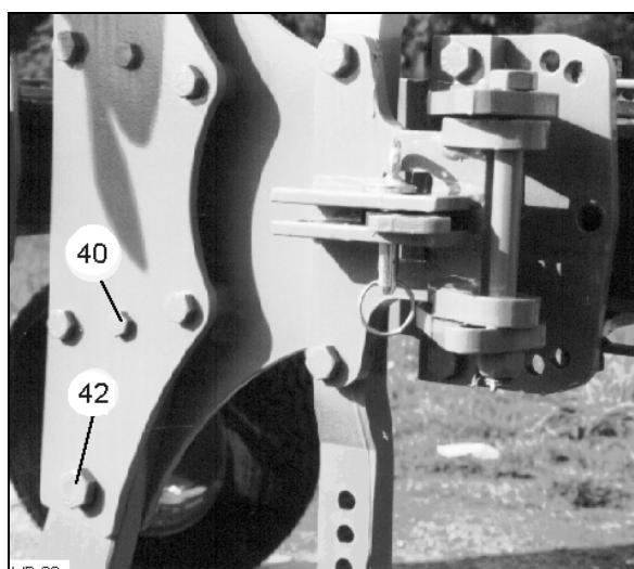
Модель ВАРИ-ДИАМАНТ 9, а также модель ВАРИ-ДИАМАНТ 9 X защищены от перегрузки при помощи предохранительных срезных винтов (40), расположенных в карманах стоек (41).
