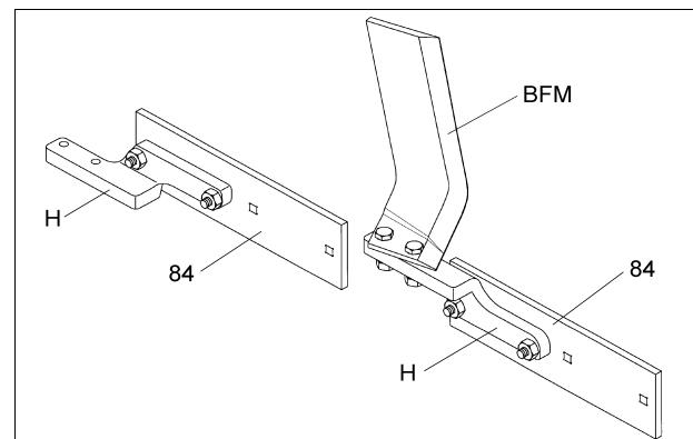
Если трактор оснащён шинами широкого сечения, то рекомендуется применение бороздоделателей-расширителей (BFM). Бороздоделатели-расширители привинчиваются к полевым доскам (84) соответствующего последнего корпуса.
