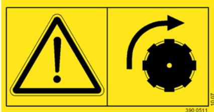
Сквозной привод вала отбора мощности вращается в правую сторону.
