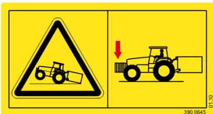
Передняя ось трактора должна быть постоянно нагружена как минимум 20% веса трактора в порожнем состоянии.
