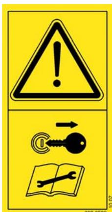
Перед техобслуживанием и ремонтными работами заглушите двигатель и вытащите ключ зажигания.
